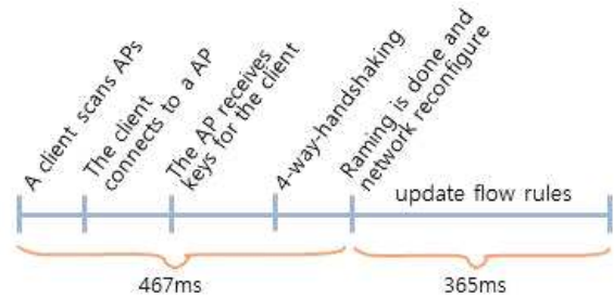
그림 19. 핸드오버 진행 타임 라인 Fig. 19. Time Line for Handover Progress
