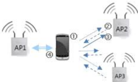
그림 5. 802.11의 핸드오버 과정 Fig. 5. Handover Process of 802.11k
