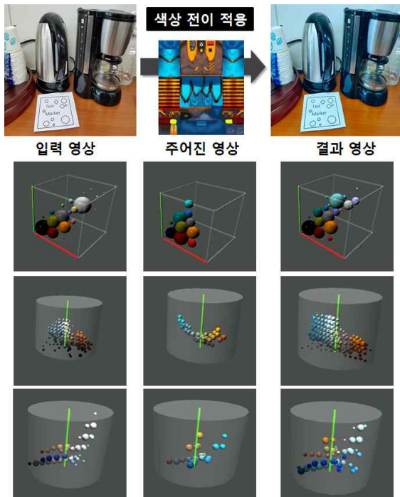
그림 10. 색상전이 적용 전후의 3차원 색상분포도 시각화 Fig. 10. 3D color distribution before and after applying color Transfer Technology
